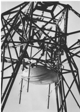
1, 815MHz 副反射鏡と 136MHz 4本のダイポール
